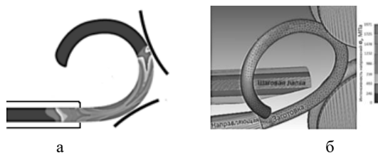
Рис.1. Двух- и трехмерная модель процесса навивки
