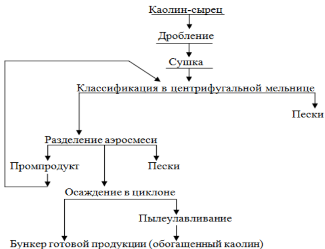
Принципиальная схема сухого обогащения каолина.
