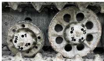
Места установки преобразователей на опорном и натяжном колесе
