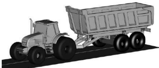
Имитационная модель тракторного поезда в программном комплексе « Universal Mechanism »
