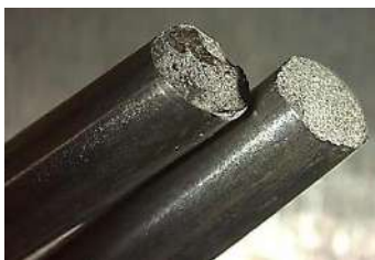
Хрупкое разрушение бунтового проката диаметром 5,5 мм
