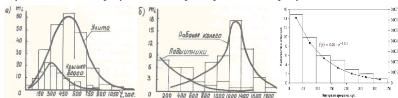
Законы распределения наработки грунтонасоса (а) и его комплектующих деталей (б, в)
