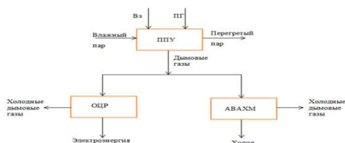
Принципиальная схема пароперегревательной установки
