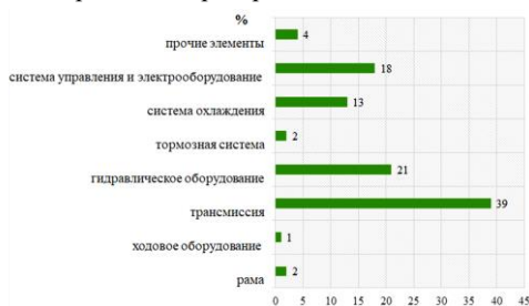
Распределение отказов ПДМ Sandvik LH по основным механизмам
